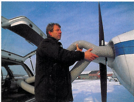
Optimal ist die Vorwärmung des kalten Motors mit Warmluft
