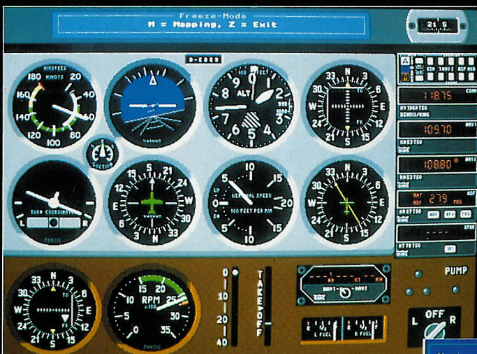
Zum Programm LAS gehört das Bedienteil LBE, rechts neben dem Bildschirm. Mit ihm lassen sich die Instrumente sehr realistisch bedienen
