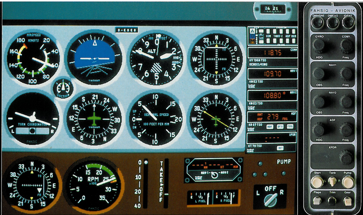
Zum Programm LAS gehört das Bedienteil LBE, rechts neben dem Bildschirm. Mit ihm lassen sich die Instrumente sehr realistisch bedienen
